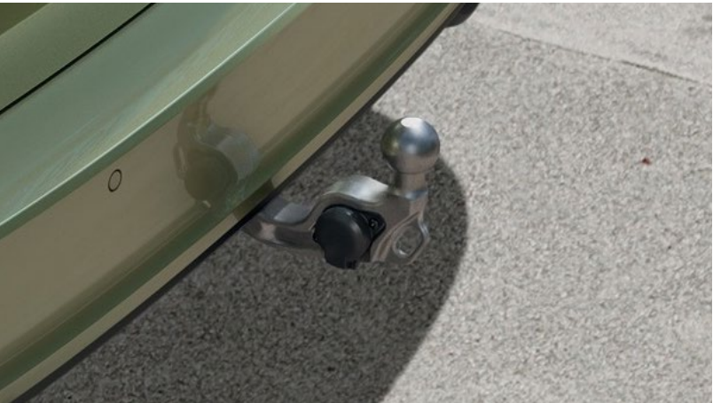
Enganche para remolque pivotable mecánicamente y extraíble eléctricamente, con adaptador
