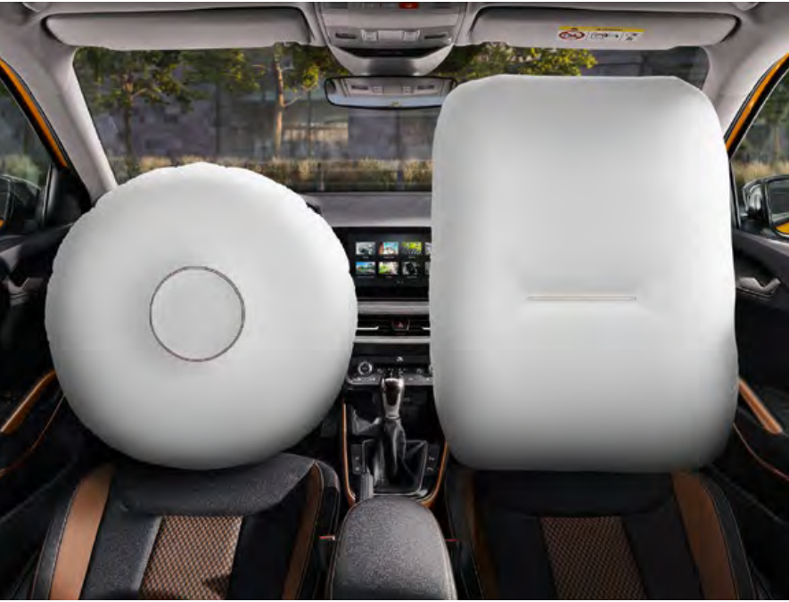
AIRBAGS PARA EL CONDUCTOR Y EL COPILOTO El airbag del conductor está confinado en el volante; el del copiloto, en el salpicadero. Si es necesario, este último se puede desactivar para instalar una silla infantil en el asiento delantero.
