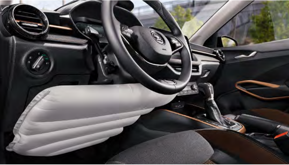
AIRBAG DE RODILLAS Este airbag se encuentra bajo la columna de dirección y protege las rodillas y espinillas del conductor.
