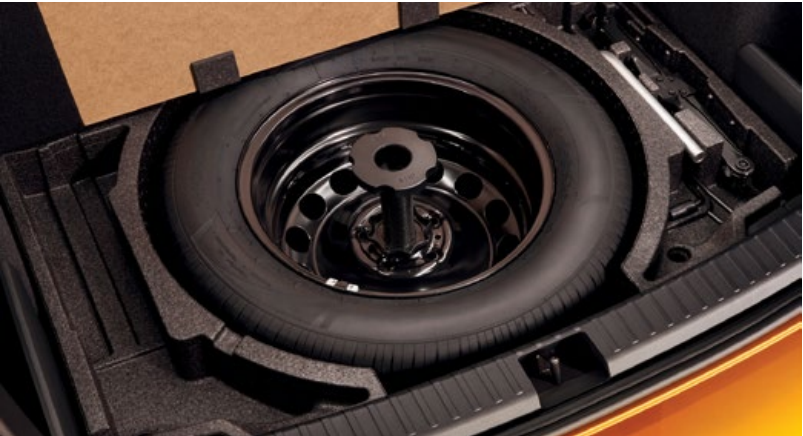
Rueda de emergencia estrecha, espacio reducido
